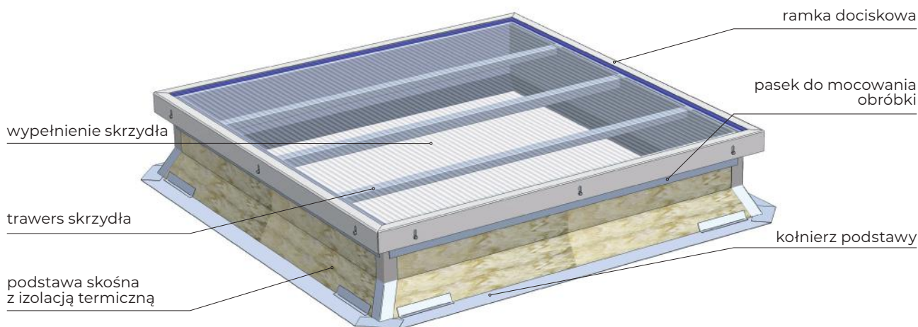
Rys. 19 Budowa świetlika stałego mcr PROLIGHT NG-A
