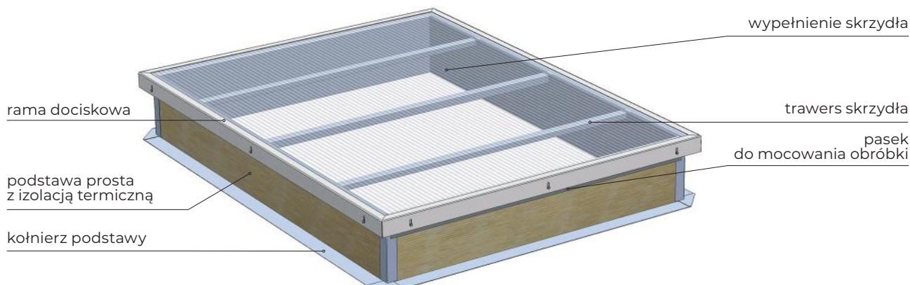
Rys. 16 Budowa świetlika stałego mcr PROLIGHT E
